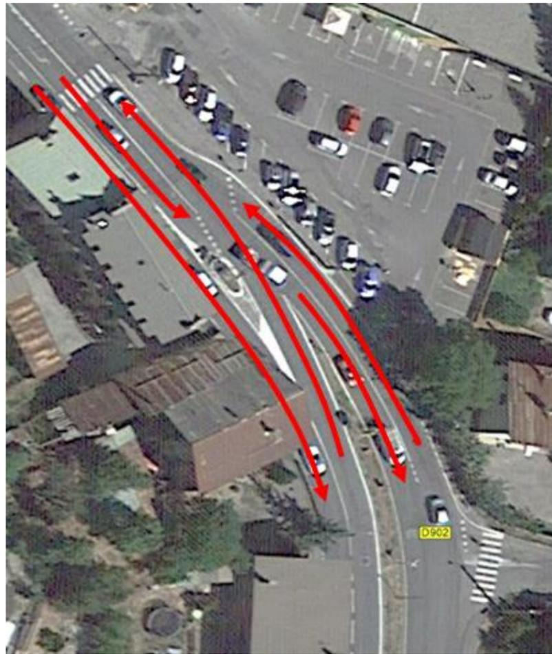
Figure 10 : Fonctionnement du carrefour RN94 / avenue du Général Barbot
