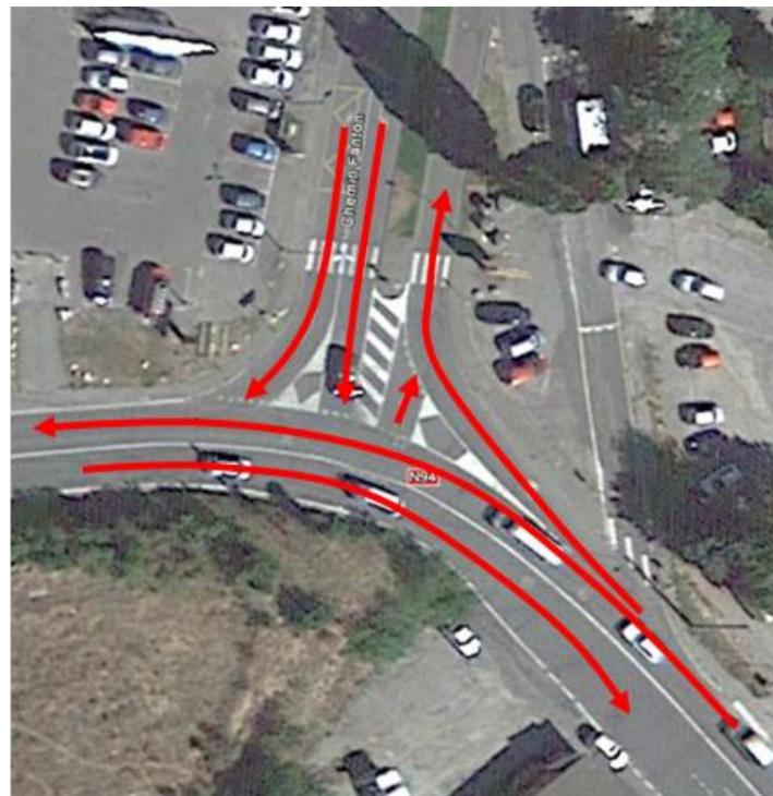
Figure 11 : Fonctionnement du carrefour RN94 / Chemin Fanton
